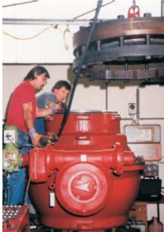
Tlaková zkouška KLINGERballostaru KHSVI podle DIN 3230
