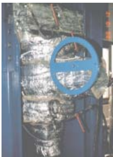
KLINGERballostar: Zkouška podle EN488
