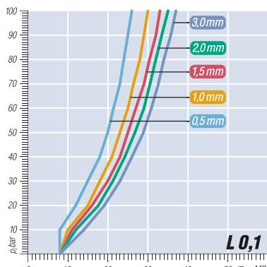
Třída těsnosti  $L = 0,1$  dovoluje maximální množství netěsnosti 0,1 mg dusíku za sekundu a metr těsnicí délky ( $mg/s \times m$ ).
